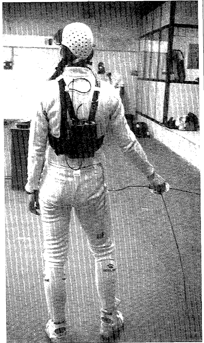
Foto 1 Col·locació de l'analitzador telemètric de gasos en un dels tiradors de la mostra.
